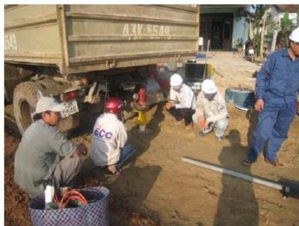
Thí nghiệm xác định mô đun đàn hồi nền đường tỉnh lộ 604- đoạn thử nghiệm gia cố đất bằng Consolid
