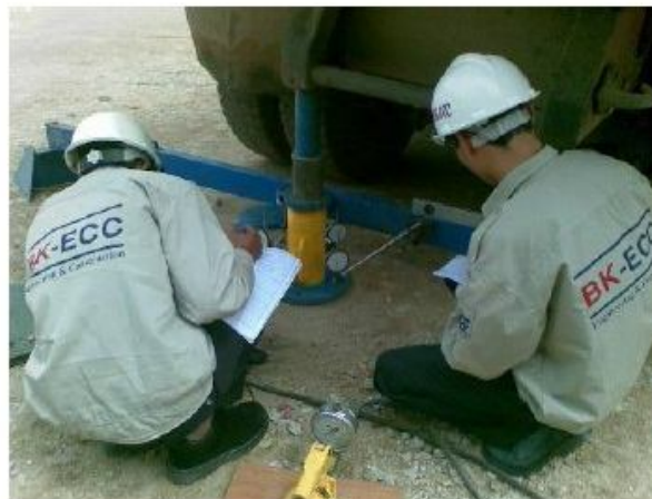
Thí nghiệm tẩm ép xác định sức chịu tải nền móng trong Dự án Nhà máy lọc dầu số 1 Dung Quất
